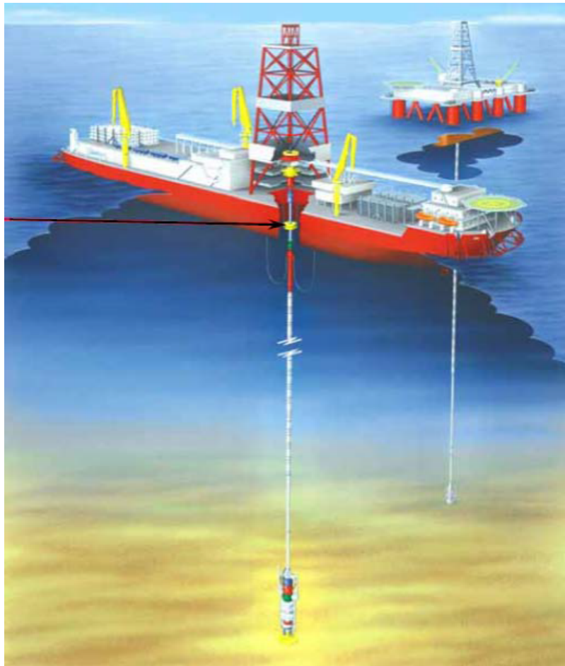
Figure 2 Illustration d'un navire de forage (avant) et d'un plateforme semi-submersible (arrière)
