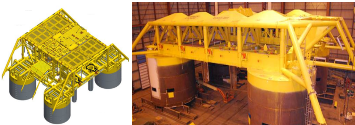
Figure 2-7 Châssis d'ancrage sous-marins représentatifs, à quatre encoches (gauche) et à huit encoches (droite)
