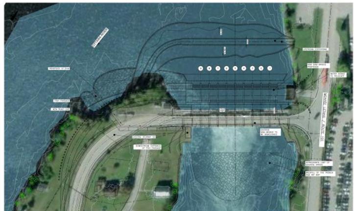
**Option 3 : Reconstruction du barrage sur le même tracé que le barrage existant et démolition du barrage existant**
