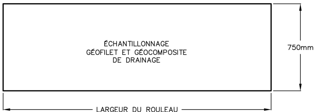
Figure 3 : Dimensions des échantillons de géofilet ou géocomposite de drainage pour les essais de conformité.
