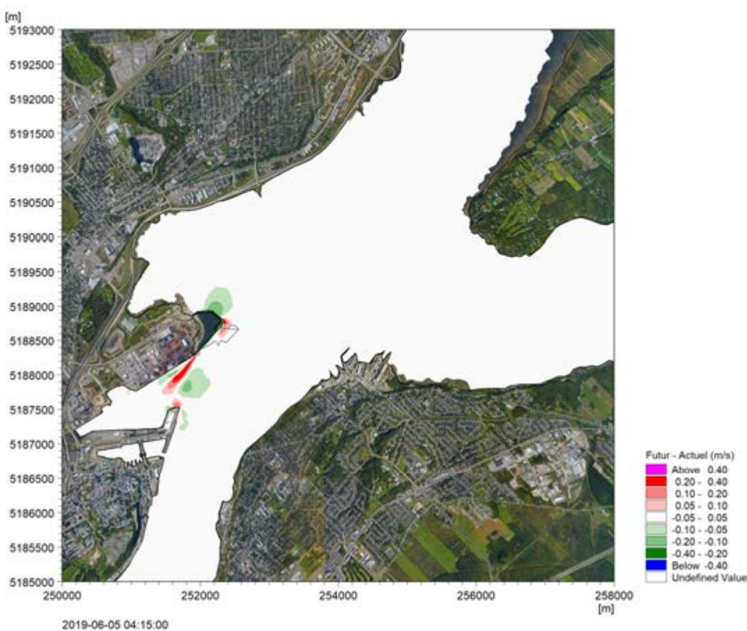
Figure 4.2a: Courants de marée de vive-eau avant et après aménagement
