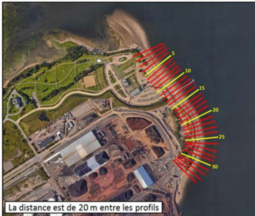
a) Sections-en-travers utilisées dans le modèle filaire
