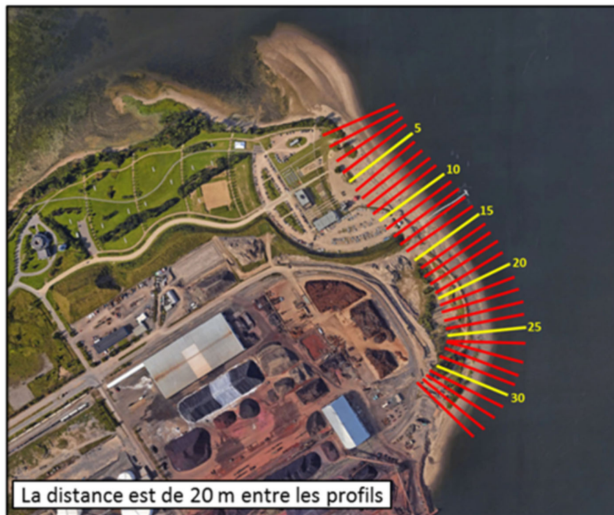
Figure 5-3 Sections en travers utilisées dans le modèle filaire (Lasalle | NHC, 2020)
