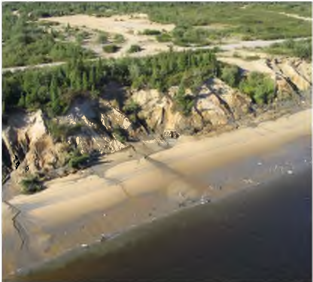
Photo 14-1 : La Grande Rivière – Talus d'environ 10 m de hauteur subissant une forte érosion par sapement basal et par éboulement, en aval de Chisasibi (rive gauche, vers le PK 10)
