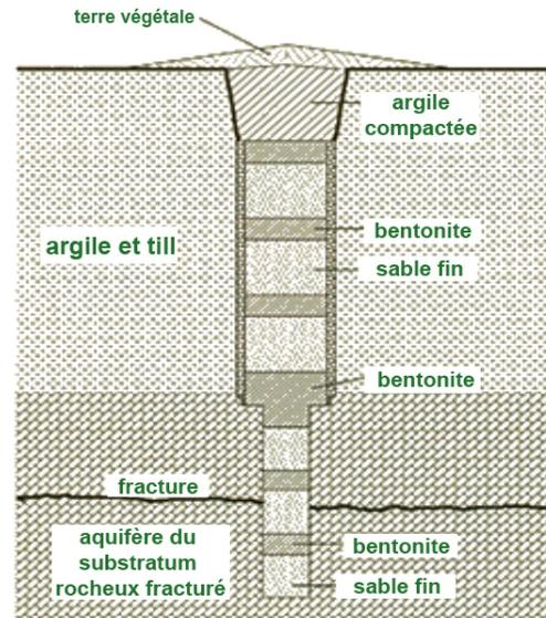
Figure 5 : Exemple de puits désaffecté de petit diamètre
