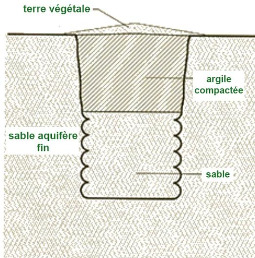
Figure 4 : Exemple de puits désaffecté de grand diamètre
