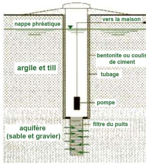
Figure 3 : Exemple de puits de petit diamètre
